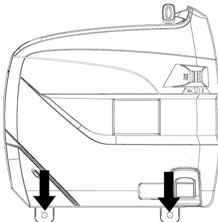
5. Desencaixe o REP da parede empurrando-o para cima e puxando-o em seguida.
