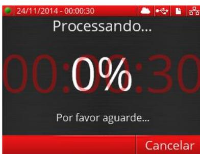
Para realizar o update de firmware primeiro insira um “Pendrive”, contendo o firmware do equipamento, na porta USB não fiscal. Em seguida pressione o botão UPDATE na tela “Sobre”. O processo de update de firmware será iniciado. Aguarde até que o processo seja completado.
